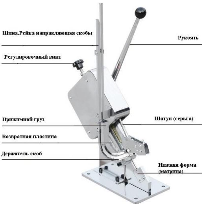
Рис 3. Общий вид оборудования. Клипсатор
